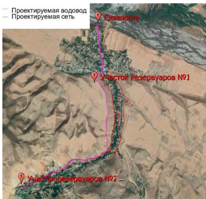
Рис. 8 Проектируемая водопроводная сеть подпроекта «Пор»
