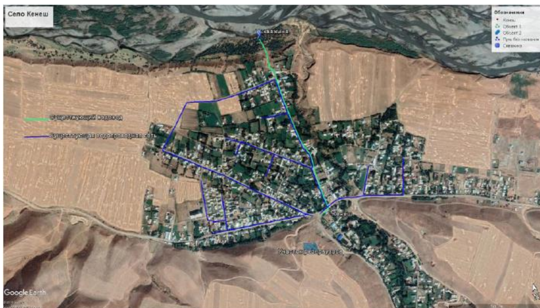
Рис.7 Существующая водопроводная сеть с. Кенеш
