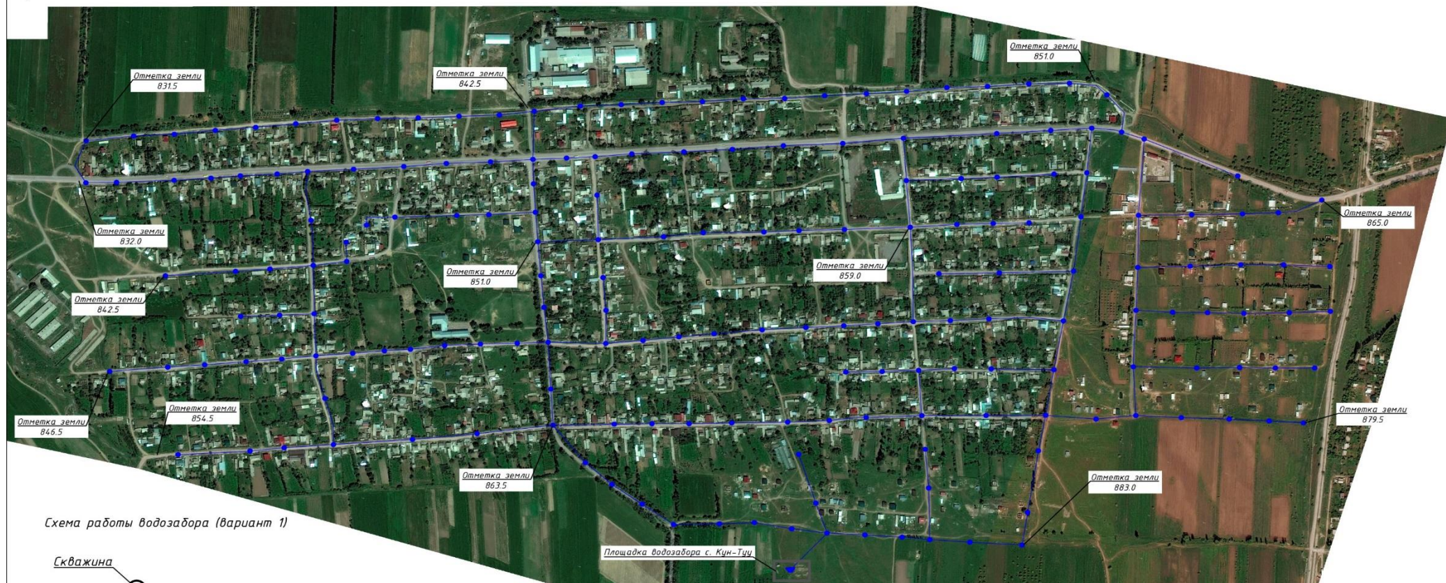
Схема проектируемой водопроводной сети с. Кун-Туу (вариант 1)
