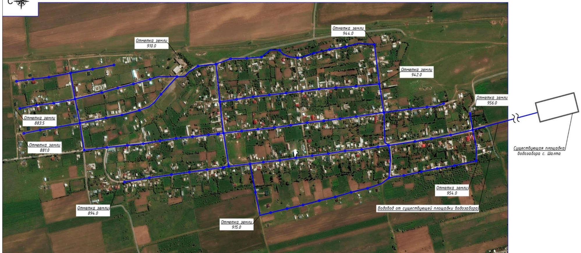
Схема проектируемой водопроводной сети с. Шалта (вариант 1 и 2)
